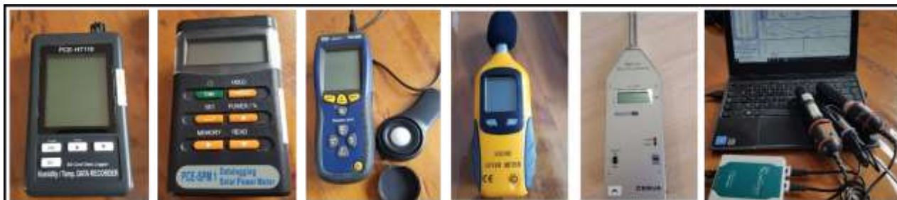
Figura 1. Higròmetre, piranòmetre, luxímetre i sonòmetre (material en préstec del CRP Horta-Guinardó). Sonòmetre i sondes de diòxid de carboni, temperatura i radiació (material en préstec del CESIRE).
